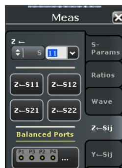
3. Tippen Sie auf das Steuerelement, z. B. "Z <-- S11".
