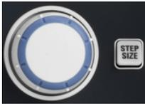
Der Drehknopf inkrementiert und dekrementiert numerische Werte, schaltet in Listen weiter, aktiviert Steuerelemente und bestätigt Eingaben. Das Drehen oder Drücken des Drehknopfs ist äquivalent zur Betätigung der Navigationstasten "Cursor Up" und "Cursor Down" bzw. der ENTER-Taste im Tastenfeld DATA ENTRY.
